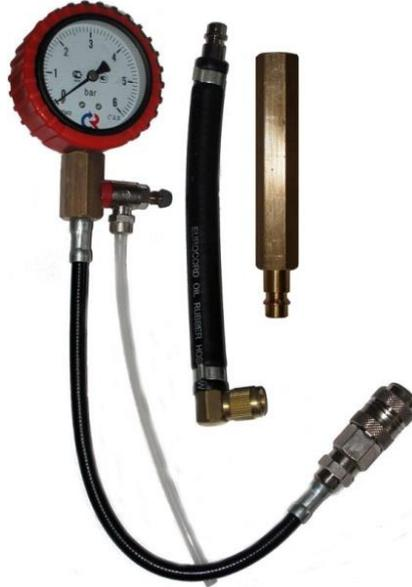
Рис. 4 Топливный манометр
