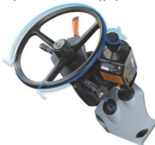
Рисунок 2: автопилот для трактора или комбайна (гидравлический или подруливающее устройство)
