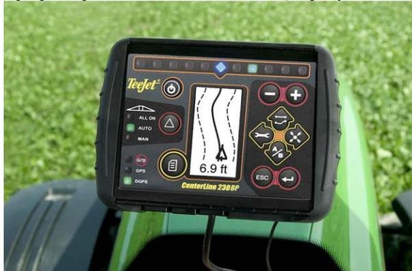
Рисунок 1: система параллельного вождения курсоуказатель, электронный маркер
